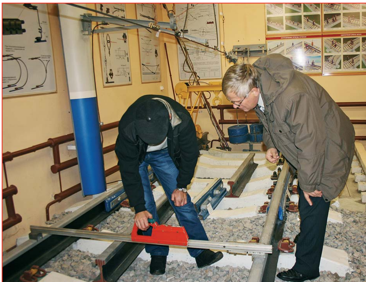
Замер ширины колеи на полигоне
